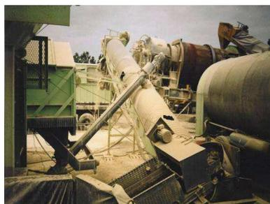
Incorporation sur élévateur à froid d'Asphacal<sup>®</sup>
